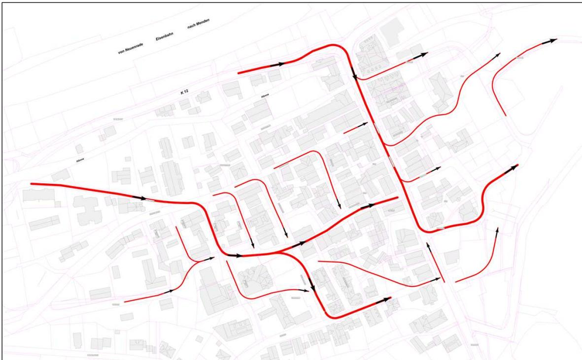
Abbildung 18: Resultierende Darstellung für die Planung Starkregenabfluss, Büro Finger
